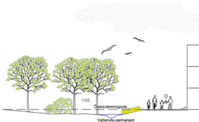
Figur 3. Exempel på blå-grönt huvudstråk i tätortsmiljö med god potential för ekosystemtjänster. Stråket innehåller en stor mångfald av värdehöjande element och multifunktionella ytor med hög funktionalitet för ekosystemtjänster. Ambitionen är att sektionen ska innehålla en flerskiktad struktur med träd-, busk- och örtskikt med god variation av inhemska arter samt möjlighet till fördröjning av dagvatten med permanent vattenyta.
